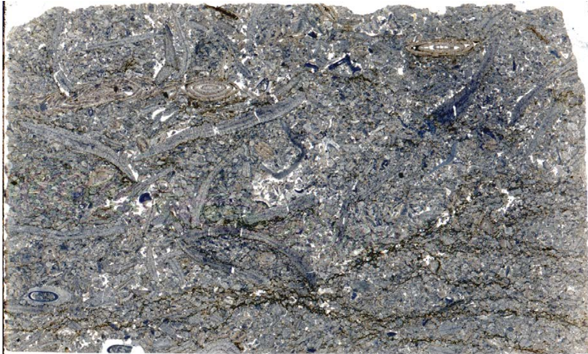
8004, overzichtsscan van het slijpplaatje, packstone met fijnverdeeld bleek sparietcement en bruine microstylolietische slierten (onderaan in beeld).
