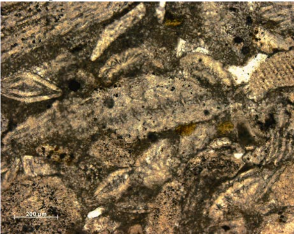
8007, bij gekruiste nicols (gepolariseerd licht) en sterkere vergroting: dichtgestapelde bioklasten, gemicritiseerd en met gecorrodeerde wanden, met afgebroken randen op de puntcontacten; voornamelijk
