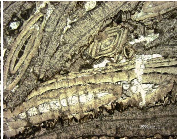
8007, bij gekruiste nicols (gepolariseerd licht): rudstone stapeling van grootforaminiferen, w.o. nummulieten en Bolkarina met microstyloliet begrenzing (bruine gekartelde randen niet zichtbaar met het blote oog).
